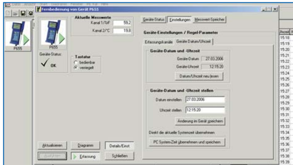
Uhrenbaustein: Uhrzeit stellen per Software Real time clock: setup by PC
