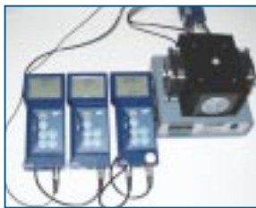
Kalibrierung von untergeordneten Prüfmitteln Calibration of subordinate measuring instruments
