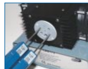
Kalibrierung von Tauchfühlern Calibration of immersion probes
